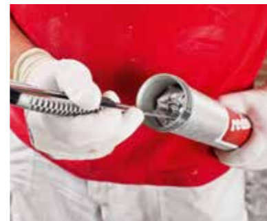
▲ 3. Einfüllen Secco Schlauchbeutelpresse mit Secco Schlauchbeutel füllen und einschneiden, anschließend Handpresse verschließen
